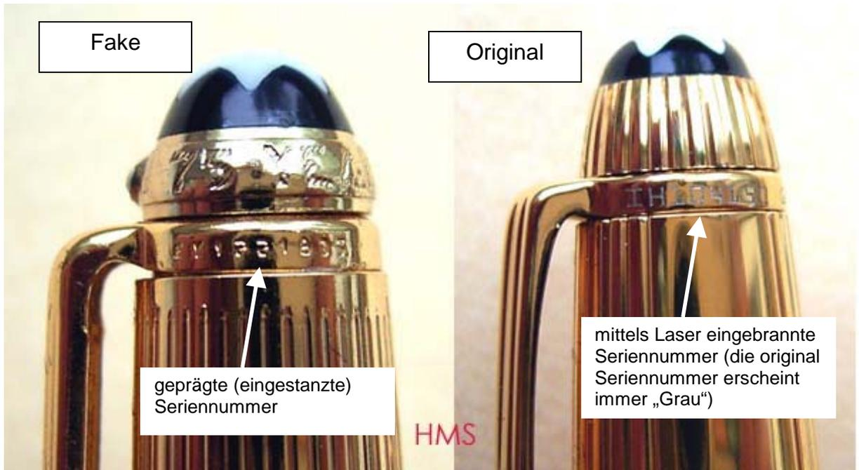
*Die Kennzeichnung bei der Kopie ist, hier deutlich zu erkennen, eingepägt. Bei dem Original ist sie mit einem Laser eingebrannt. Daher scheint diese etwas „grau“. Jede Kennzeichnung, die wie eingedrückt erscheint, ist eine Fälschung.*
